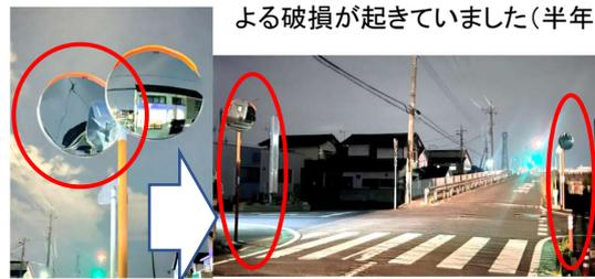
ミラーが2枚付いている箇所、毎回衝突による破損が起きていました(半年で2回交換)。
